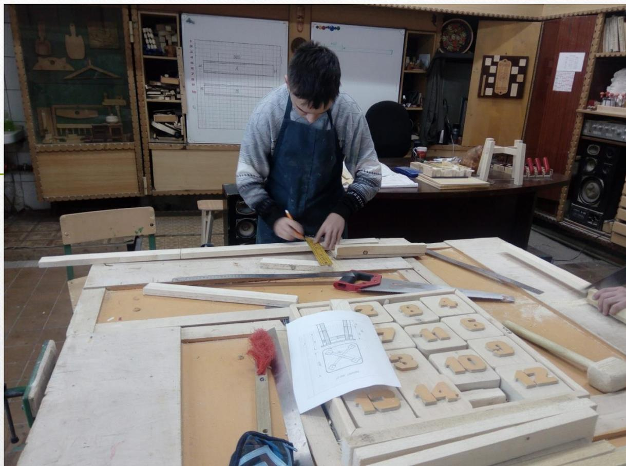
Разметка заготовок деталей
